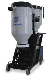
Es un aspirador industrial especialmente diseñado para rectificadoras y utiliza principalmente separador ciclónico y HEPA13 como dispositivo de filtrado. El separador ciclónico se encarga de filtrar la mayoría de las partículas de polvo, una pequeña parte del polvo liviano se filtra con HEPA13, por lo que el efecto de aspiración es particularmente bueno.
