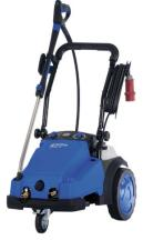
Ha sido equipada y mejorada con la bomba industrial C3 con 4 pistones cerámicos, rodamientos cilíndricos dobles, sistema de control activado por flujo y motor de 1450 rpm. Apta para utilizar con agua hasta 85°C, la bomba C3 ha sido también probada utilizando agua salada: para llevar a cabo las tareas más agresivas. El resultado es una mejor distribución de la carga de trabajo en la bomba, lo cual reduce la vibración de la máquina, ofreciendo así un funcionamiento más fino y silencioso.
