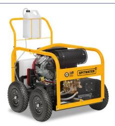
Esta hidrolavadora ofrece alto rendimiento y eficiencia con respaldo de repuestos de clase mundial. Tanque de enfriamiento (exclusivo de SPITWATER) en toda la gama industrial. Protege los sellos de la bomba contra el sobrecalentamiento cuando la máquina está en derivación (modo de gatillo cerrado), lo que garantiza una vida útil más prolongada de la bomba y menos mantenimiento.
